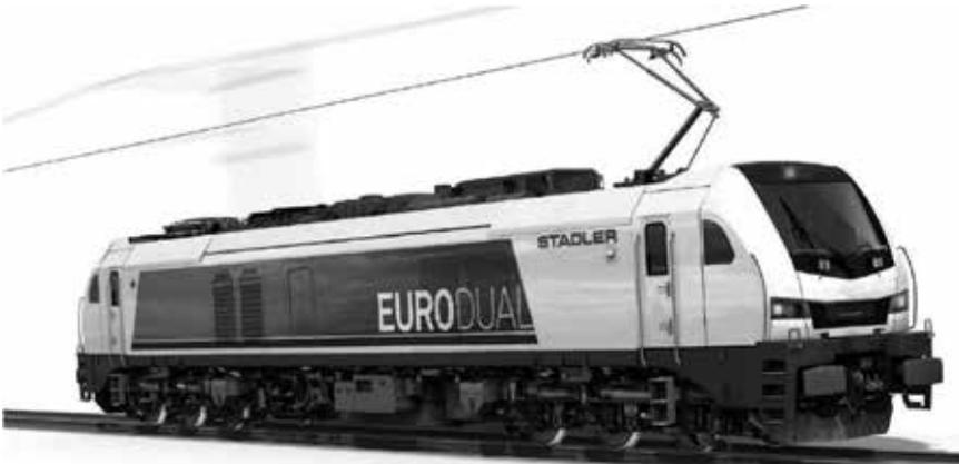
Die sechssachsige bimodale Güterverkehrslok von Stadler Rail ist für zukünftig schwere Züge (740 Meter, 2'000 Tonnen) und die „Last Mile“ (Terminals und Anschlussgleise ohne Elektrifizierung) entwickelt worden (Quelle: Stadler Rail Group).
