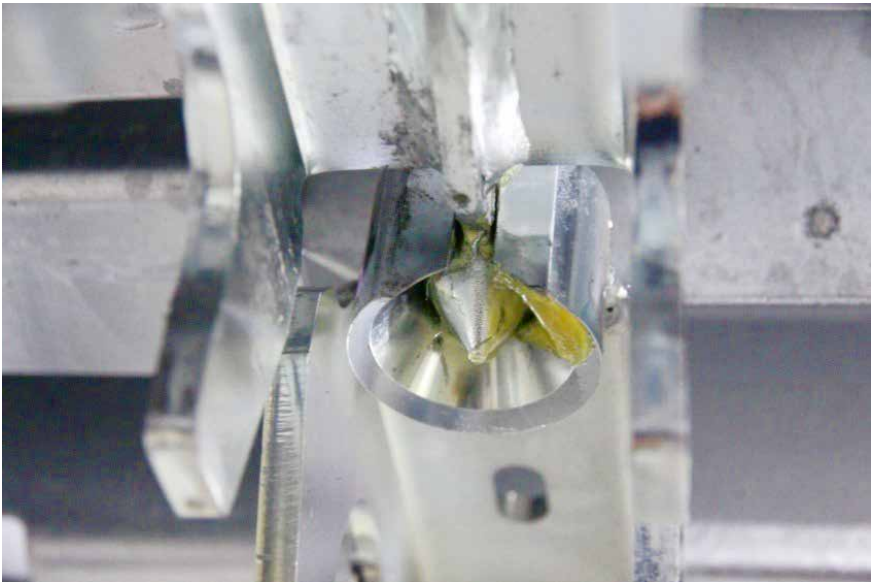
Bild 16: Kupplung einer Parkpalette mit den weiterentwickelten angeschweißten Dornen und den konischen Aufnahmen
