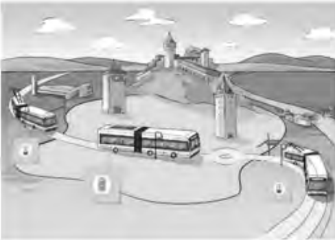
Abbildung 2: Schaffhausen rüstet in Etappen vom klassischen Trolleybus-Betrieb zum E-Bus: Aufladen unter dem Fahrdraht und Überbrücken mit Energie von der Batterie
