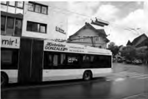
Abbildung 3: IMC-Trolleybus der vbsh beim Eindrahten mit Hilfe des «Eindraht-Trichters» am Anfang der Oberleitungsstrecke in Neuhausen Zentrum
